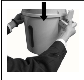
A. Remove the dust bucket
